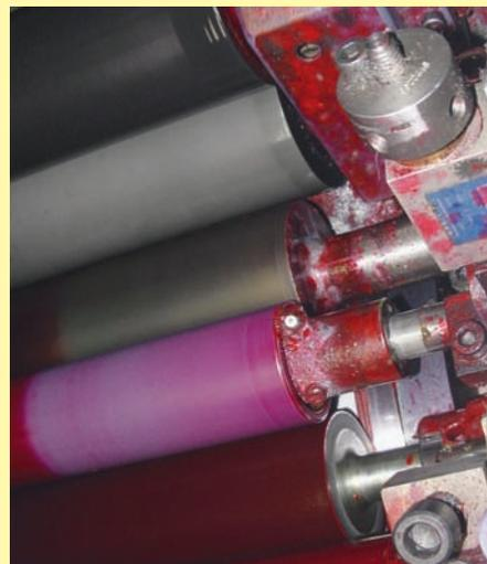
**Stark verschmutzte Komponenten mindern den Zeitwert der Druckmaschine.**
